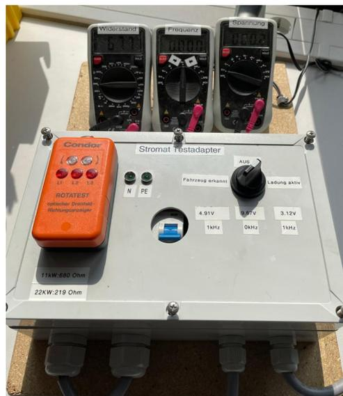
Abbildung 1 Alter Prüfaufbau mit Multimeter, Drehfeldtester und Kontrollleuchten
